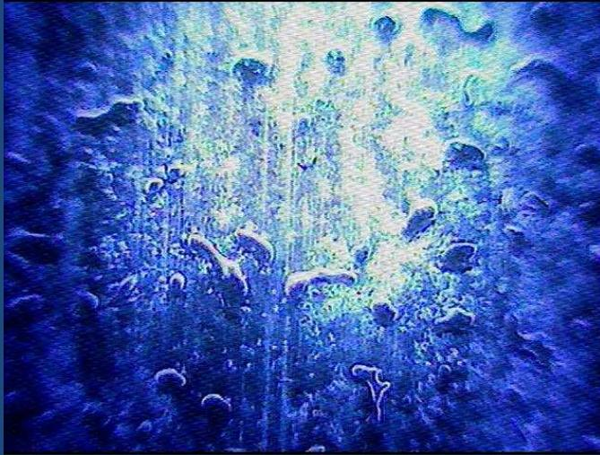
Image de la fluorescence de globules d'hydrocarbures dans le sol à 7m37.
