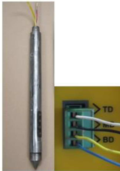
Figure 5.2: sonde HPT et connexions EC
